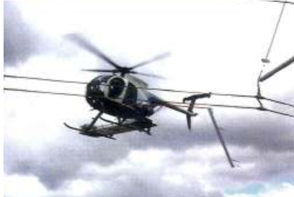
Slika 4 – Skidanje zaštitnog omotača iz helikoptera [3]
