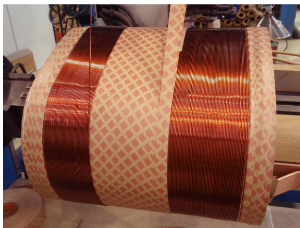
Slika 4. Proces namatanja VN namota sa izolacijom u trakama od dijamantnog papira
