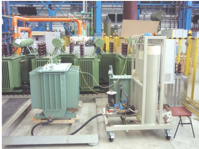
Slika 10. Ispitivanje hermetički zatvorenog kotla na ciklička opterećenja
