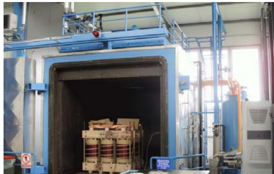
Slika 5. Klasična metoda sušenja aktivnog dijela transformatora u vakuumskoj komori.
