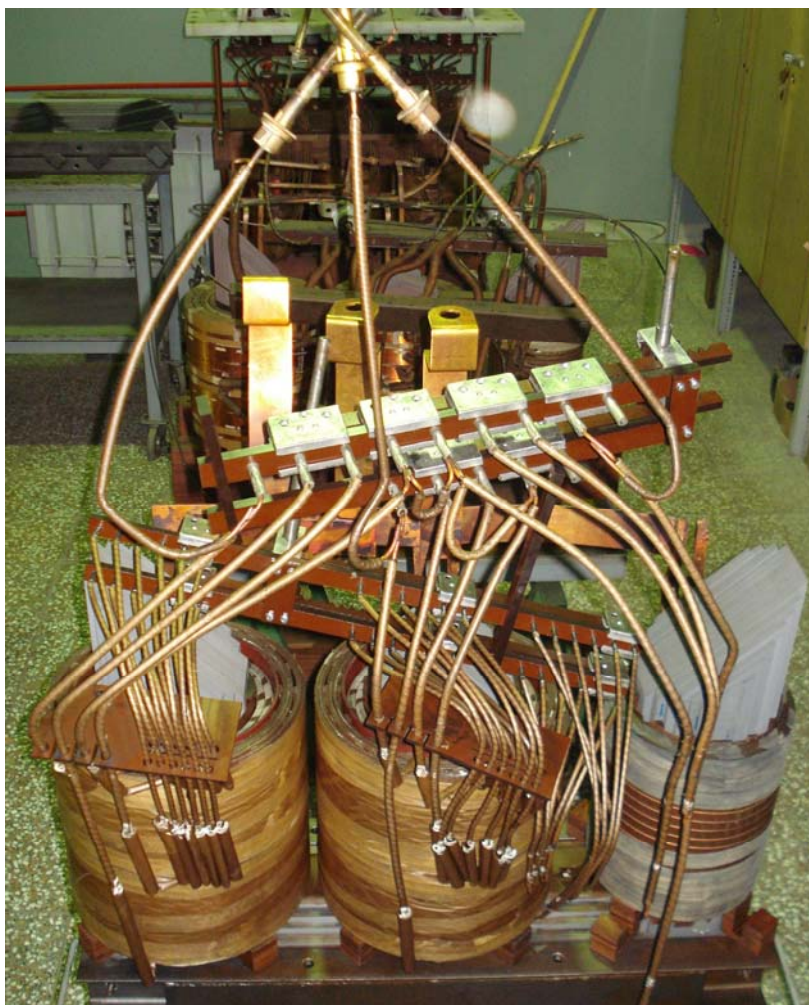
Slika 3. Transformator sa regulacionom preklopkom 2 x \pm 2.5\% i preklopkom 20(10) kV
