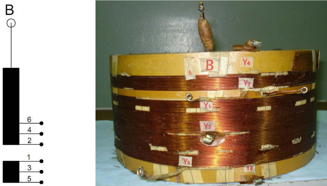
Slika 6. Šematski prikaz namotaja (polunamotaj) sa regulacijom (lijevo) i stvarni izgleda namotaja sa izvodima za regulaciju (desno)
